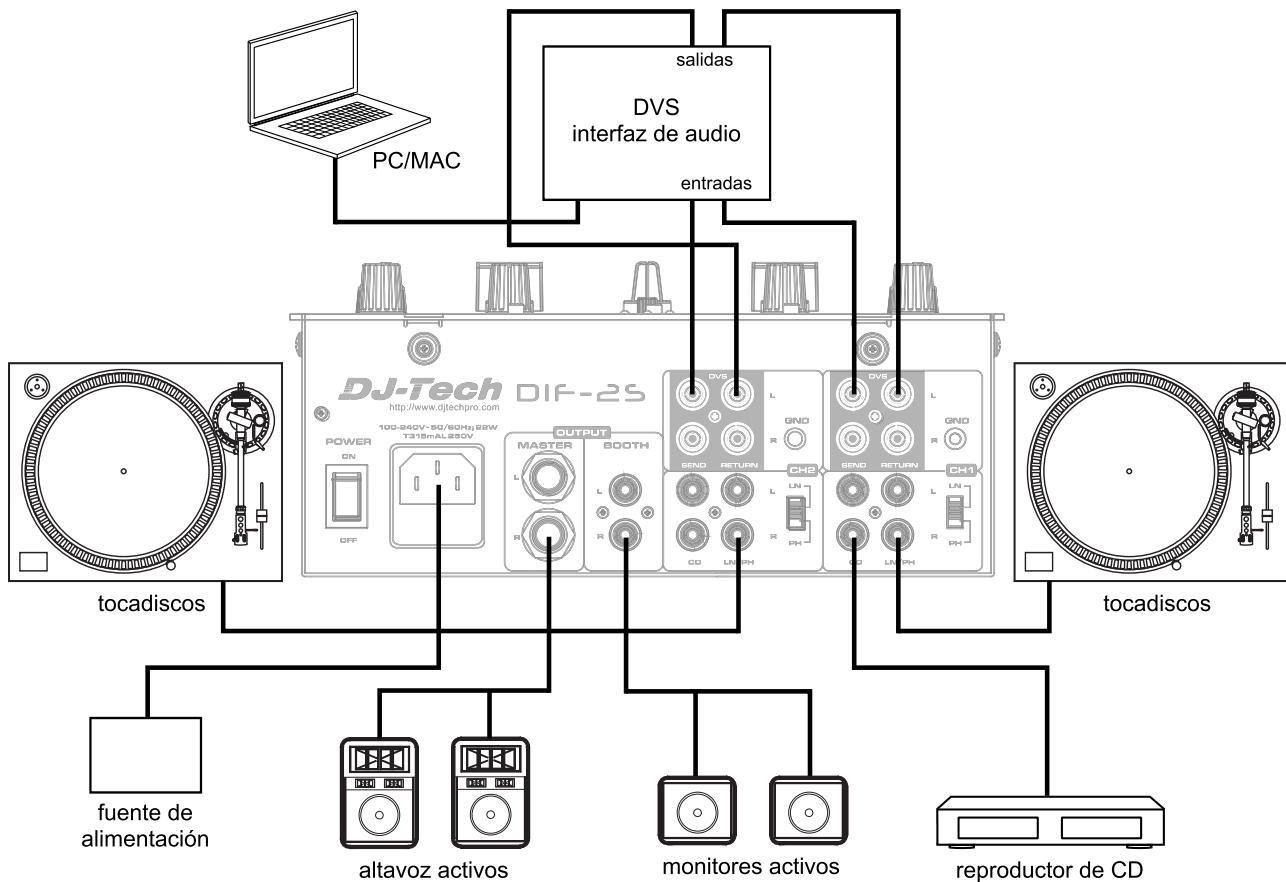
Ejemplo de conexión típica se muestra en el diagrama anterior.
